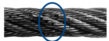
Fig. 43: Wire break nest
